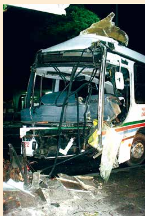
O choque com a árvore destruiu a frente do ônibus e destruiu a área destinada ao usuário
